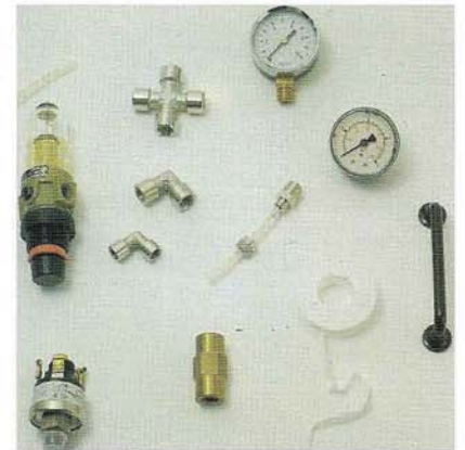
Ингредиенты, необходимые для изготовления компрессионной установки моделиста.
