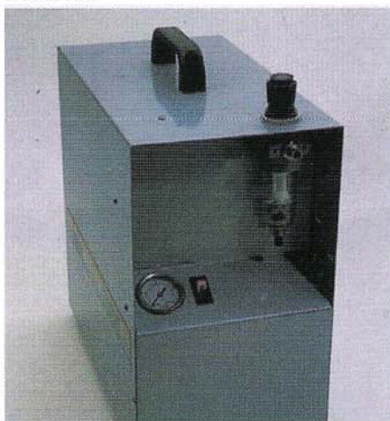
Современный компрессор компактен и тих в работе. От него можно одновременно запитать сразу три аэрографа. И опять главный недостаток - высокая стоимость такого устройства.
